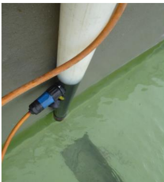
[Pegelmessgerät zur Dichtheitsprüfung am 30.11.2019]
